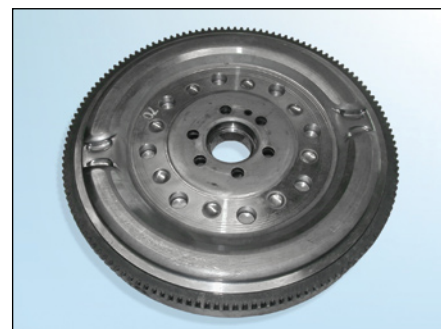
Image 4: Double volant amortisseur Sachs
