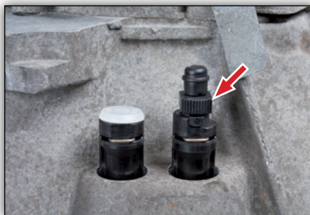
Image 8 : Le raccord de purge peut être actionné à la main ou à l'aide d'une clé mixte (13 mm)
