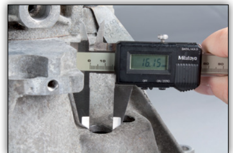
Image 2 : Si le diamètre est inférieur à 21 mm, procéder à un alésage de min. 21 mm et max. 24 mm
