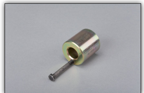
Image 3 : les volants bimasse avec tenon-guide nécessitent l'utilisation d'une douille de centrage (400 0076 10)
