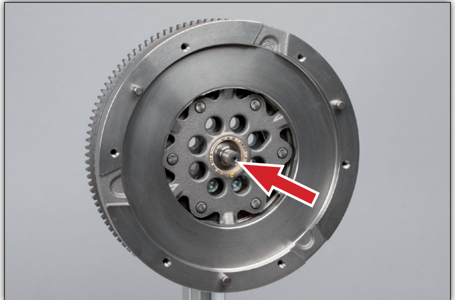
Image 1 : tenon-guide sur le volant bimasse 415 0377 10
