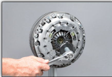
Image 8 : dévisser et retirer la pièce de verrouillage avec un outil approprié. Vous n'en avez plus besoin
