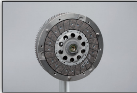
Image 5 : appliquer le disque d'embrayage
