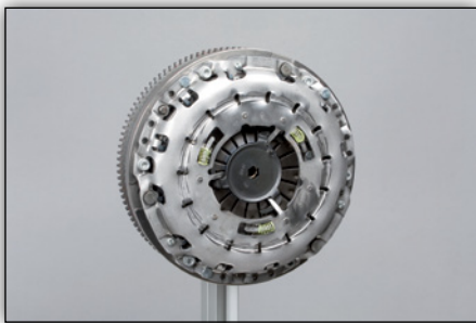
Image 7 : mettre le plateau d'embrayage et les vis en place, serrer au couple de serrage prescrit par le constructeur
