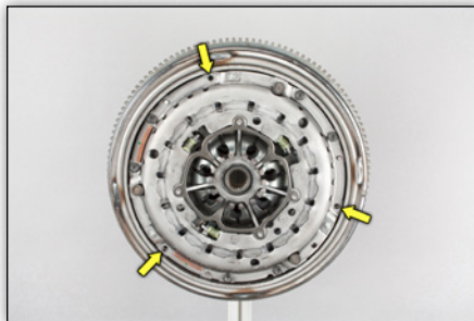
Image 9 : vissez à la main les 3 vis restantes, puis serrez-les à fond à un couple de serrage de 10,5±1 Nm
