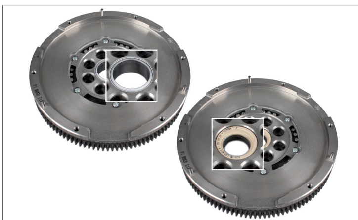
Photo 1: Le volant bimasse de LuK réf. 415 0388 10: comparaison entre la version à palier lisse (à gauche) et celle à roulement à billes (à droite)
