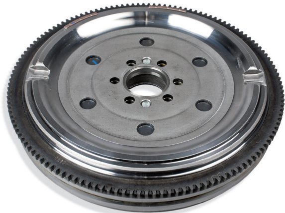
Photo 1 : Volant bimasse de LuK avec rainure sur le bord extérieur
