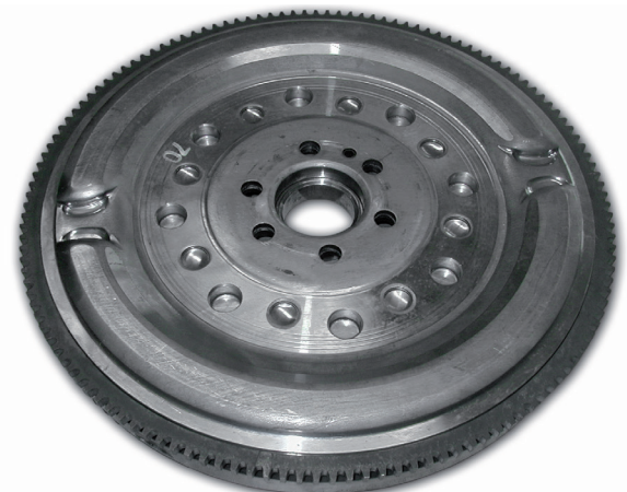
Photo 2 : Volant bimasse de SACHS sans rainure sur le bord extérieur
