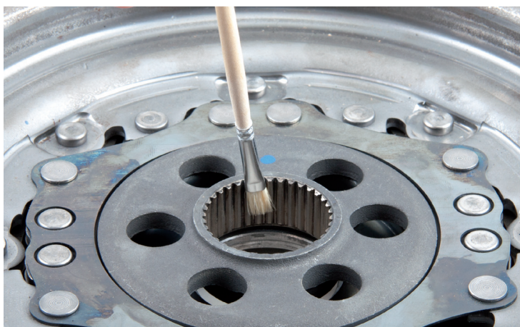
Photo 1 : Graisser légèrement la cannelure intérieure du volant bimasse à chaque réparation
