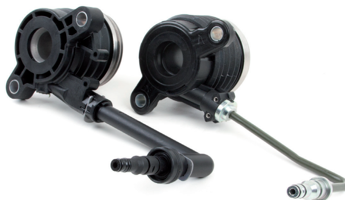
Photo 2 : Butées hydrauliques avec petits raccords
