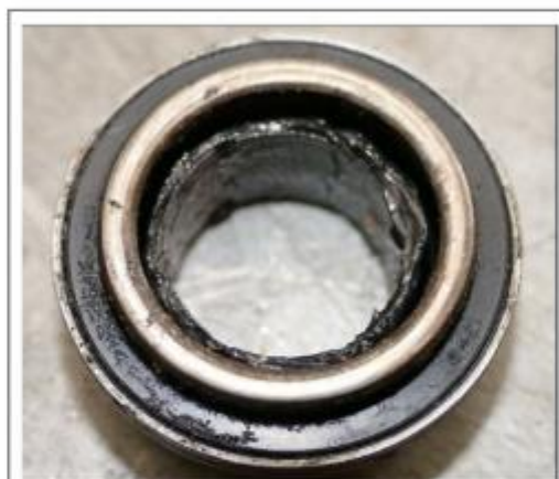
Fig. 5 Excès de Graisse sur le corps de la butée en composite
