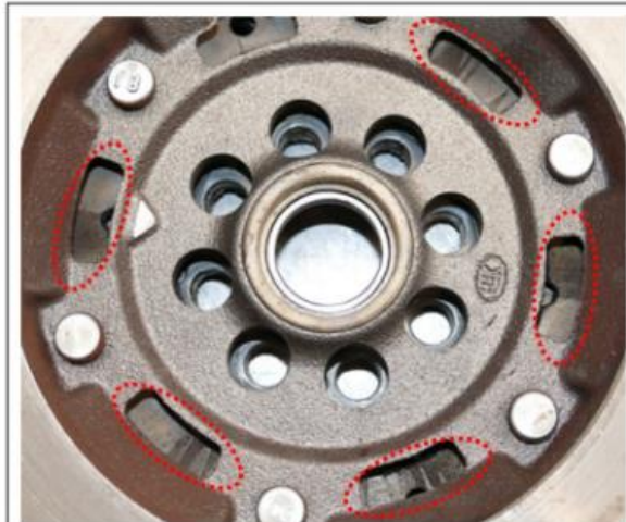
Fig. 1 Projection d'huile à l'intérieur de la masse primaire
