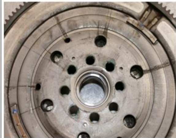
Fig. 2 Projection d'huile au dos du volant bimasse
