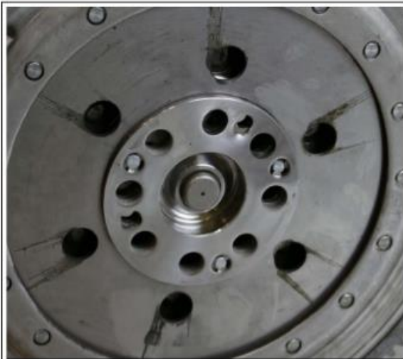
Fuite de graisse du volant bimasse Image n°1
