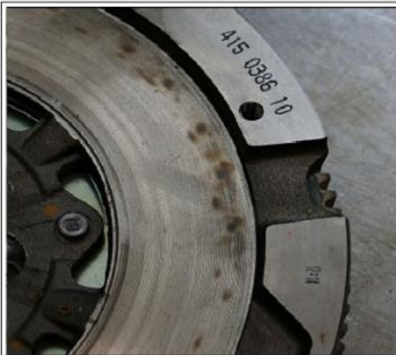
Fuite de graisse du volant bimasse Image n°2
